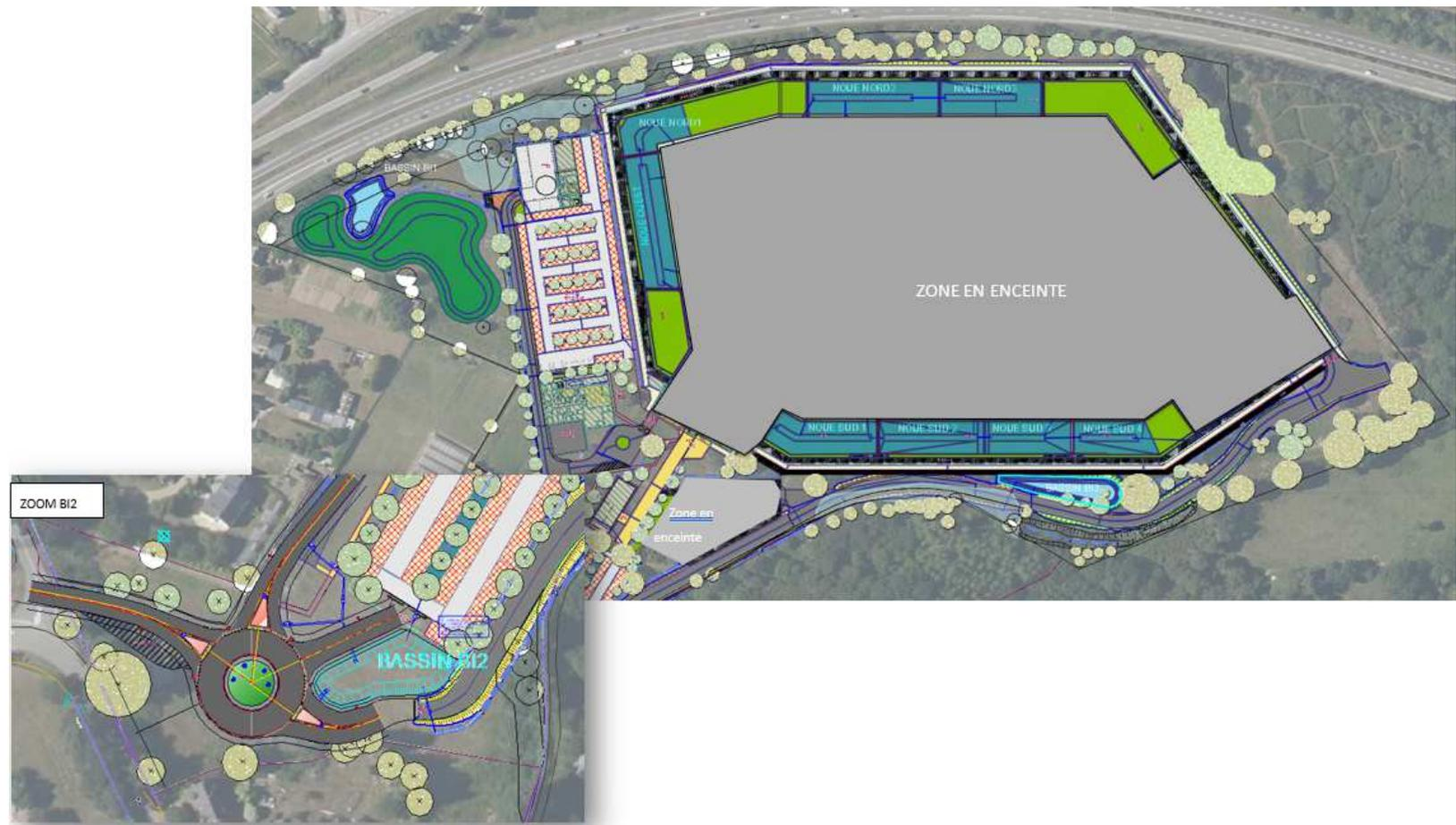
Figure 128 : Localisation des ouvrages de gestion des eaux de pluie – centre pénitentiaire, hors enceinte (Source : B4 Design & Engineering, note hydraulique de gestion des eaux pluviales, décembre 2024)
