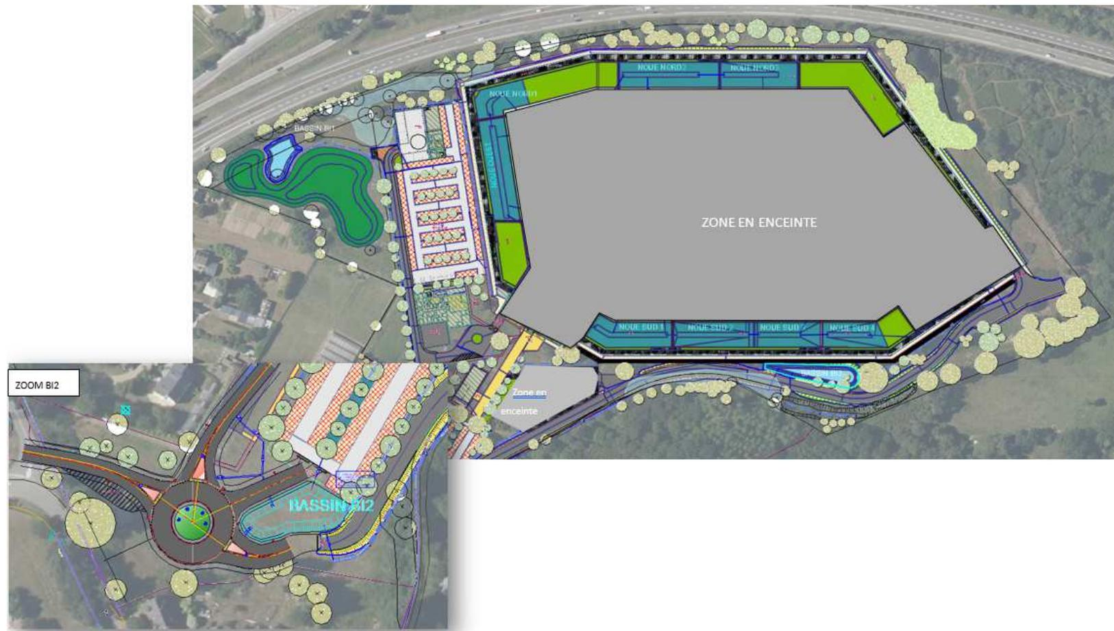
Figure 30 : Localisation des ouvrages de gestion des eaux de pluie hors enceinte (Source : B4 Design & Engineering, note hydraulique de gestion des eaux pluviales, décembre 2024)
